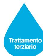
Rimozione di azoto e fosforo: rimozione spinta dei solidi sospesi; distruzione di microorganismi patogeni (disinfezione)
